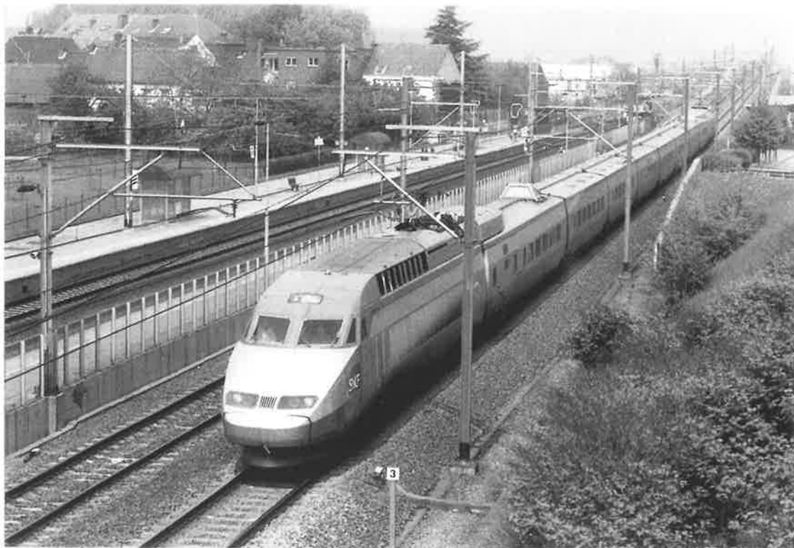
La voiture d'essai «Mélusine» incorporée derrière l'une des motrices d'une rame TGV «réseau» est actuellement remplacée par une nouvelle rame de mesures résultant de la transformation de la rame «réseau» n° 4530. Elle parcourt toutes les trois semaines l'ensemble du réseau TGV «Nord» y compris notre LI examinant particulièrement le comportement des pantographes. Lot; le 10 mai 2006 – photo Christian Dosogne
